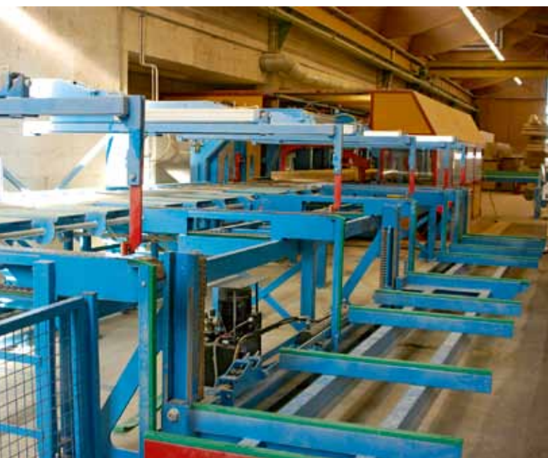
Material-Zuführung mit Hubtisch und automatischer Entstapelung ...
