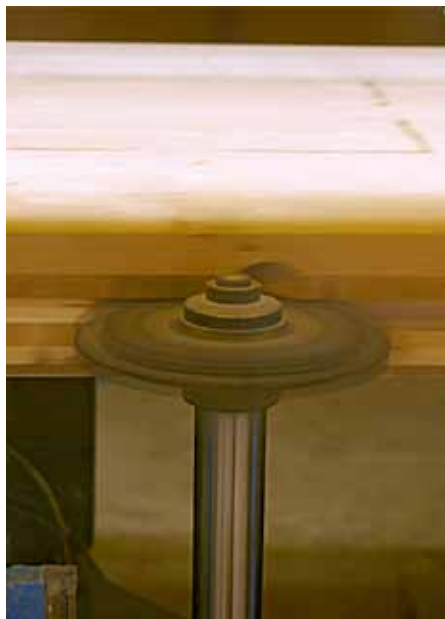
Seitliches Nuten eines BSP-Elementes in der K2i-1250
