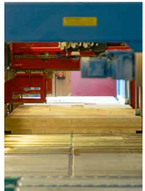
Durchlaufbreite ist auf 1250 mm erweitert worden – Bearbeitung von Standard BSP-Bauteilen
