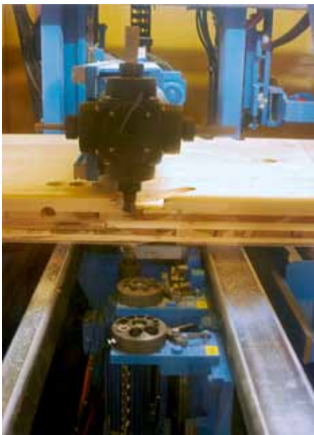
Beidseitige Bearbeitung ist mit der K2i-1250 bei Schafferer möglich
