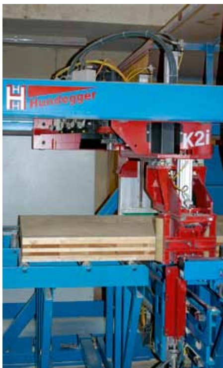
Verletzungsfreie Bearbeitung: Die Werkstücke führen gummierte Einziegreifer
