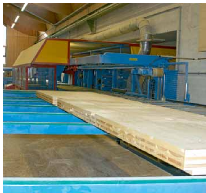
... und Material-Ausförderung an der K2i-1250 bei Schafferer
