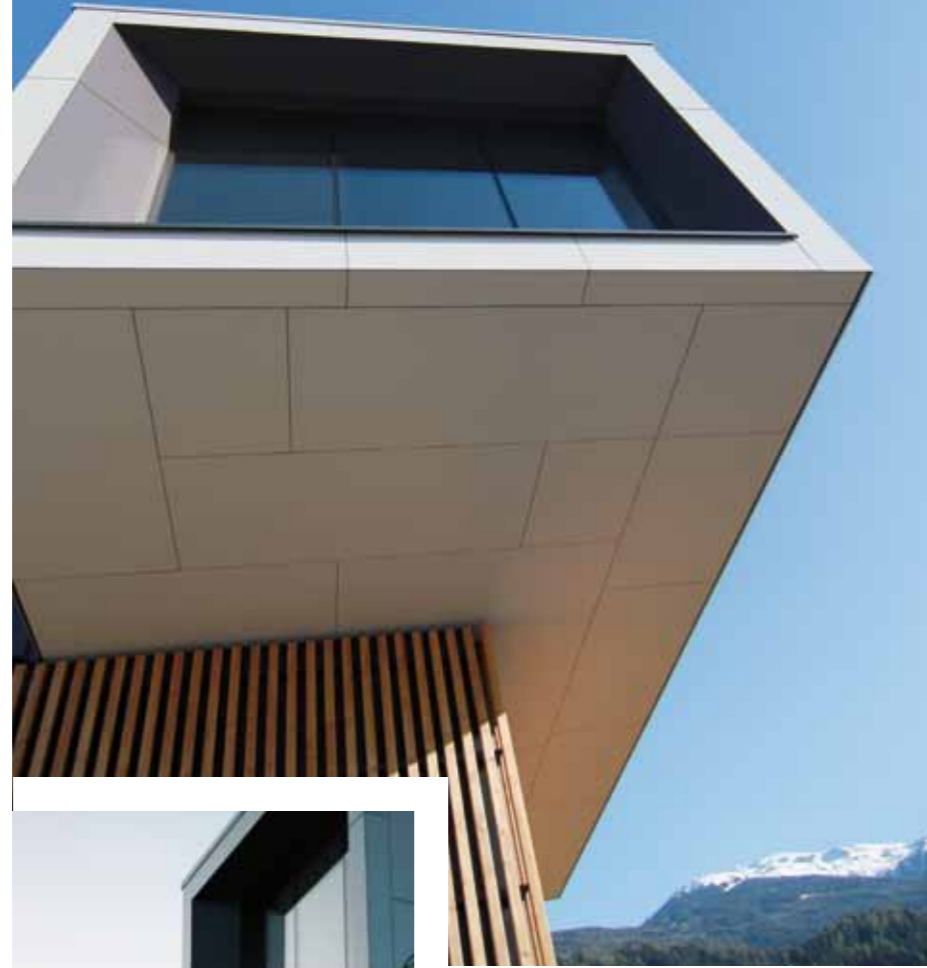
Das neue Maschinenringgebäude in Mils versprüht optischen Charme: Das Erdgeschoß wurde in Massiv-, der erste Stock in Holzbauweise errichtet.
